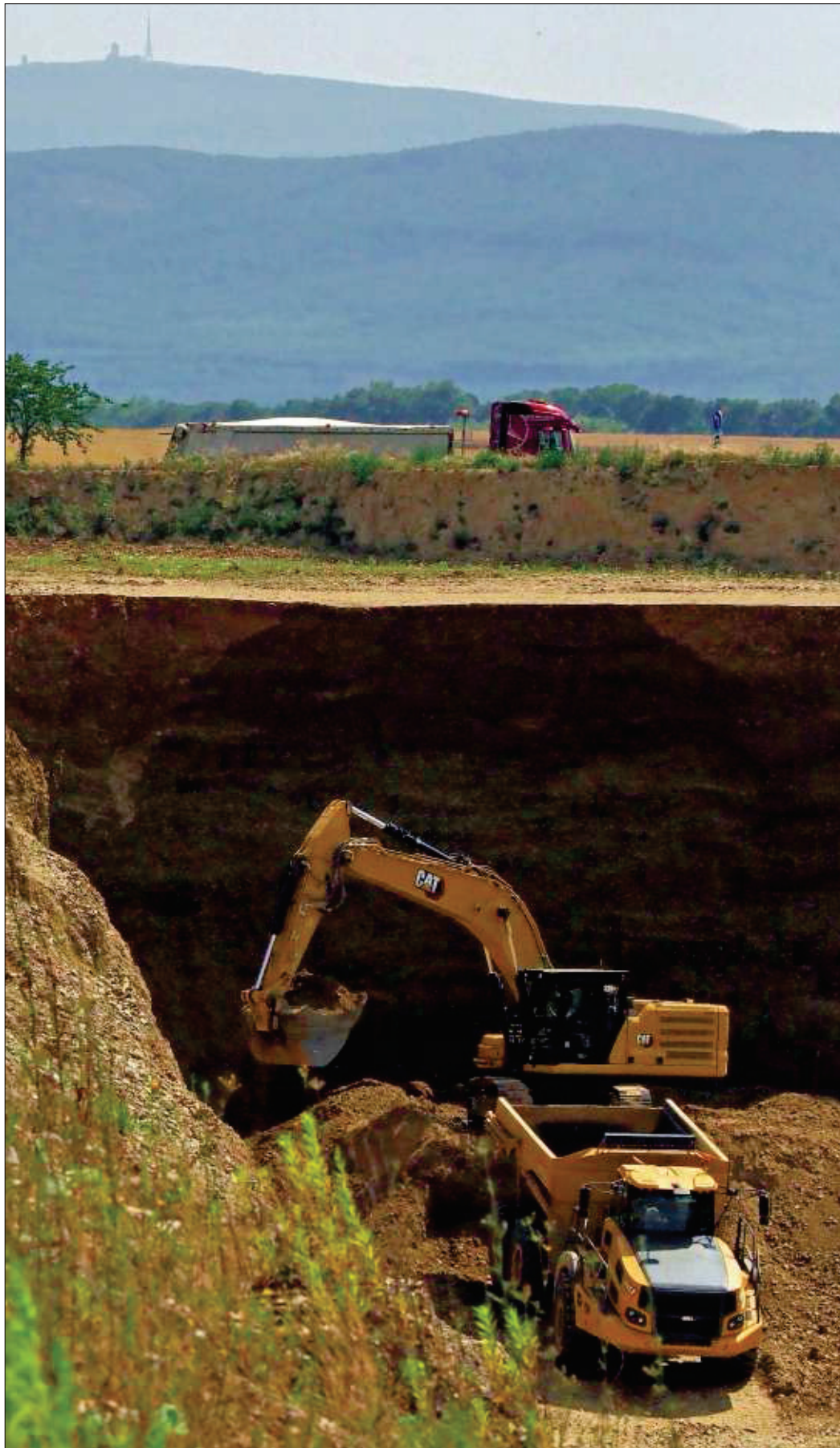
In 20 Meter Tiefe wird derzeit der Kies gewonnen. Per Bagger wird der Rohstoff auf den Dumper geladen, der ihn zur Aufbereitungsanlage auf dem Werksgelände fährt.
